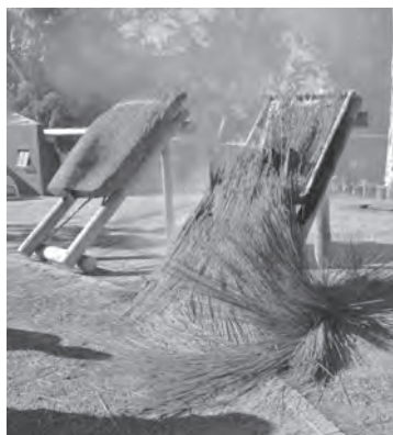
▲着火実験 手前が通常、奥が難燃処理を施した茅葺き屋根（写真7）
