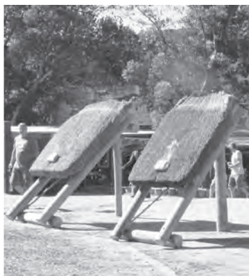
▲着火実験 手前が通常、奥が難燃処理を施した茅葺き屋根（写真7）
